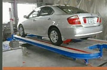
当社では、ミリ単位のフレーム修正を可能にするフレーム修正マシンを導入。これを使用することにより、事故等で損傷した自動車のフレーム構造を損傷以前の状態まで正確に復元します。
