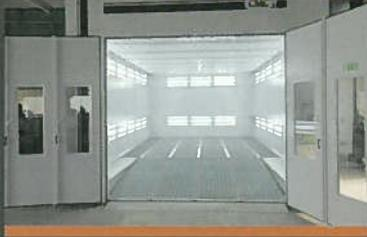
塗装作業の大敵である空気中のゴミやホコリをシャットアウトする塗装ブース内において補修塗装を行ない、補修塗膜のトラブルを防ぎ、高品質な仕上がりを実現します。
